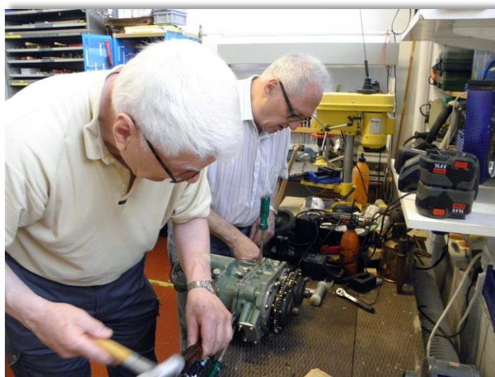
Göran och Pelle demonterar en bränslepump till RM6 så att vi kan visa ingående detaljer bl.a. kolvar som är justerbara för att ändra bränslemängden under flygningen.
